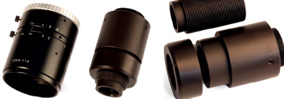
Links: 50 mm Standardobjektiv gerechnet für eine Auflösung von 3,45 \mu Pixeln. Rechts: kundenspezifische Variante, 50 mm Objektiv gerechnet für 2,2 \mu Pixelgröße, 660 nm, beugungsbegrenzt.
